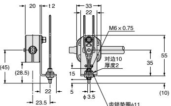
(注1): 上图适用于M6螺纹型光纤。
