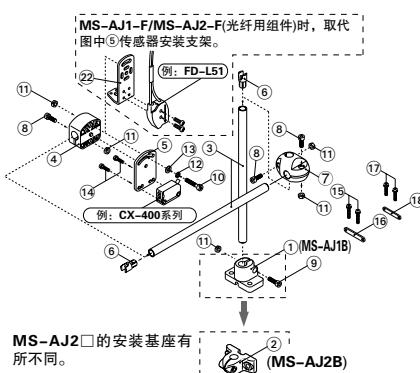
(注1): 调整侧臂安装基座(图中⑦时, 将固定侧臂的M4(长12mm)内六角螺栓(图中⑧点)松开2处后再调整较为方便。
