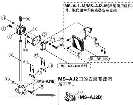
(注1): 反射镜用组件(MS-AJ□-M)上不附带电缆导管(图中⑥)。
